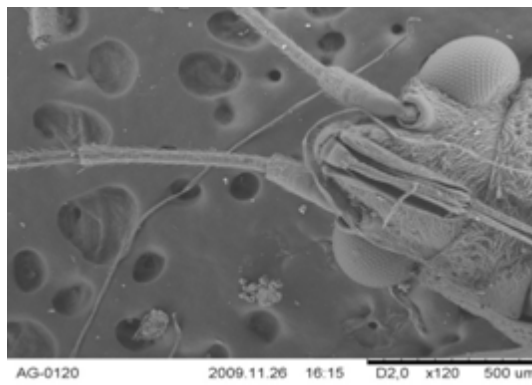
8. att. Skenējošais elektronmikroskops un mušas galvas attēls tajā 120 reīzu palielinājumā
