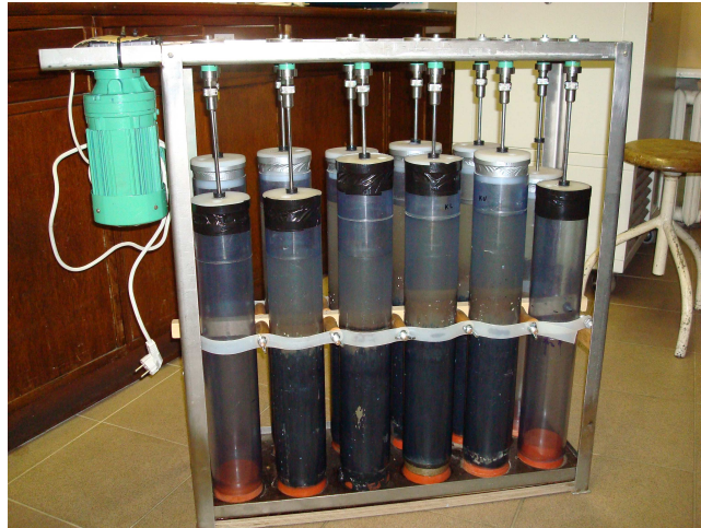
5.1. attēls. Ūdens-sedimentu robežslāņu procesu pētīšanā izmantotā sistēma.
