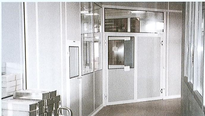
Die flexible Ständer-Riegelkonstruktion passt sich an komplexe Raumstrukturen oder technische Gegebenheiten an.
